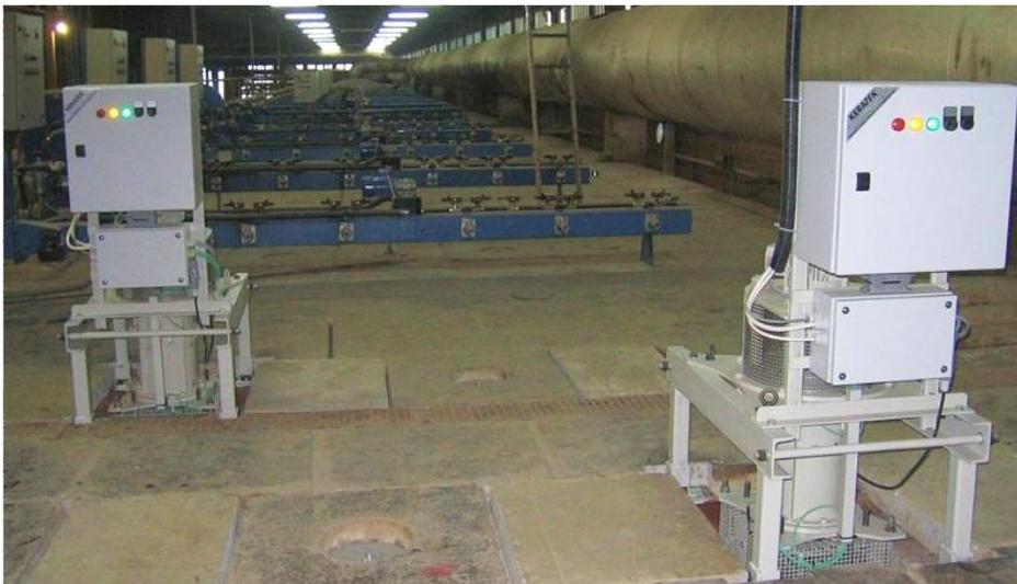
Der TURBO-BLOCK 800 lässt sich aufgrund seiner geringen Baugröße in kleinen und großen Öfen gleichermaßen flexibel einsetzen; z.B. mehrere Einheiten nebeneinander bei breiten Öfen oder in Verbindung mit HG-Brenner als "aufheizbare" Umwälzzone.
